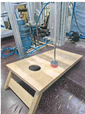
Slika 2 Prikaz izvedbe vertikalne statične obremenitve
